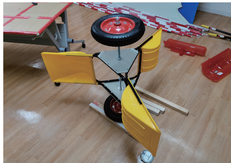
子ども用雪かき道具と手押し車の車輪をベアリングにしたメインタービンの完成品 The finished main turbine made out of kids' yukikaki snow shovels with wheelbarrow wheels as bearings
