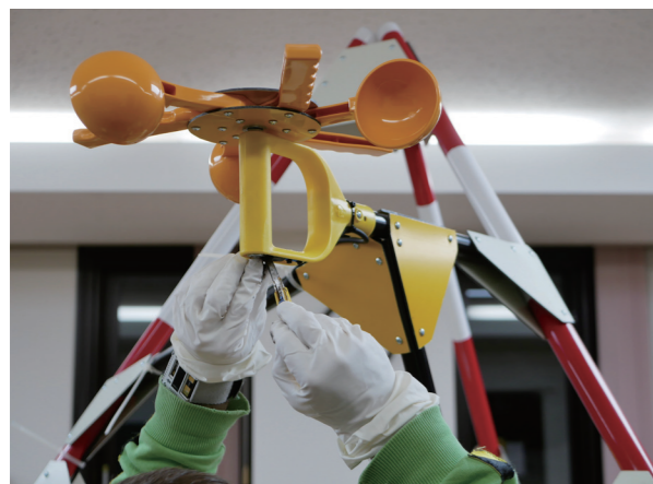
先端のローターにマグネットセンサーを接着 Gluing a magnet sensor into place at the top rotor
