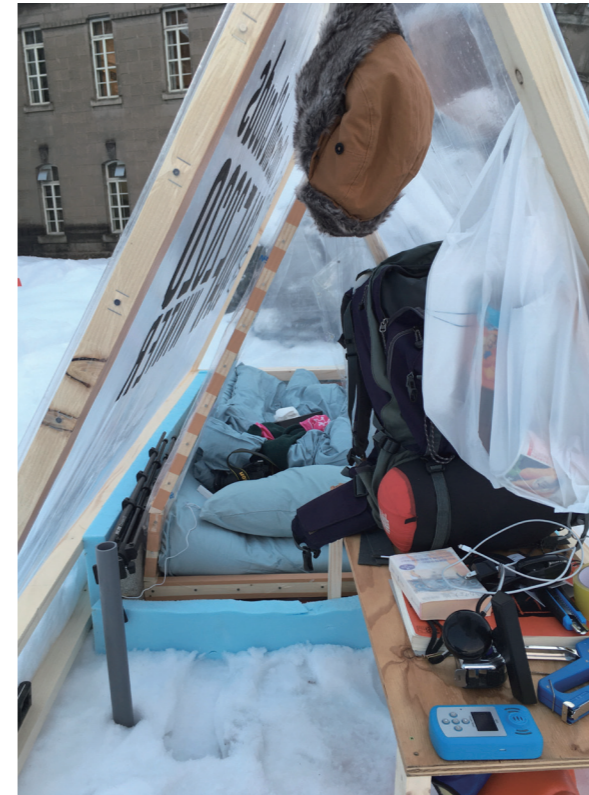
2020年2月に札幌市資料館(旧札幌控訴院)前で行った《広告看板の家》のための実験の様子。温床内温度が30度、室内温度は15度を記録
