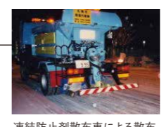
凍結防止剤散布車による散布
